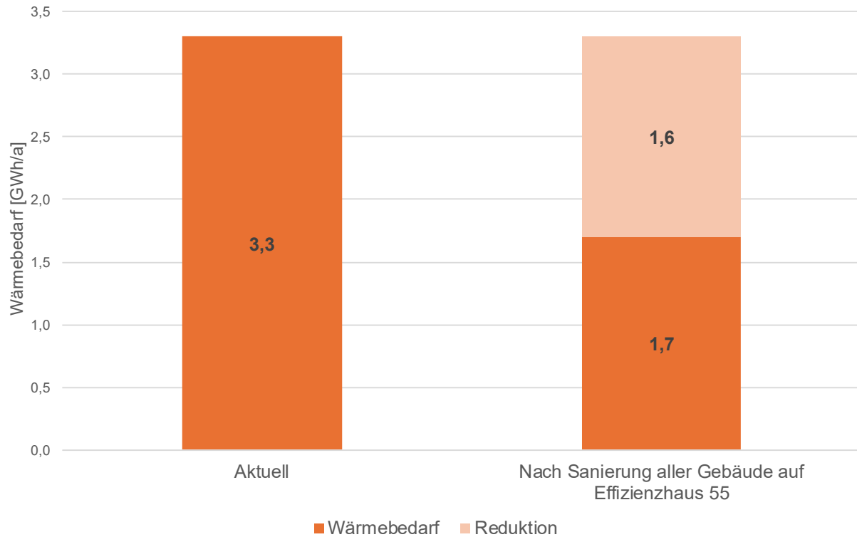
Abbildung 4-14: Theoretisches Einsparpotenzial bei Sanierung aller Gebäude auf Effizienzhaus 55 Standard
